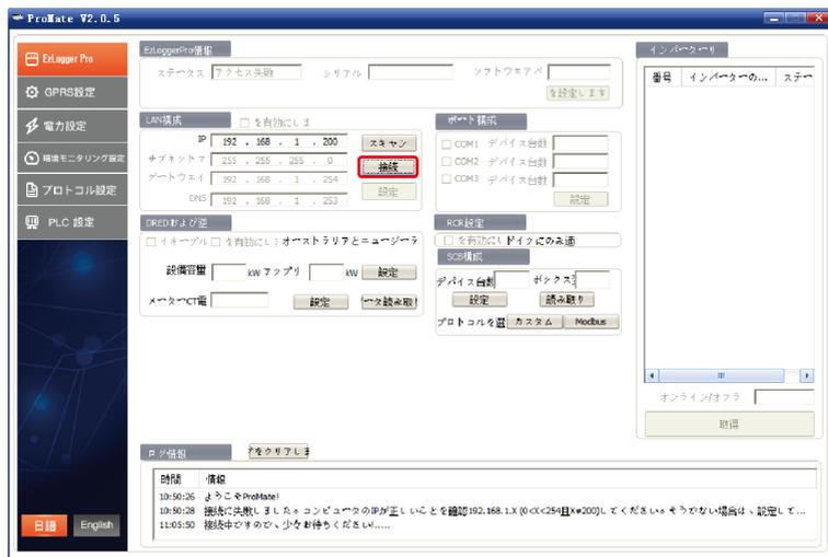
図 5.2-6 静的IPを使用したProMateソフトウェアとEzLogger Pro間の接続
